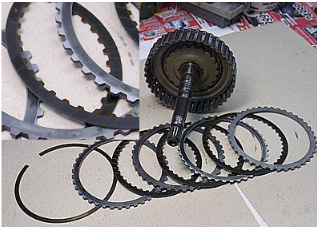
Фото 5: Сцепление включения прямой передачи.
