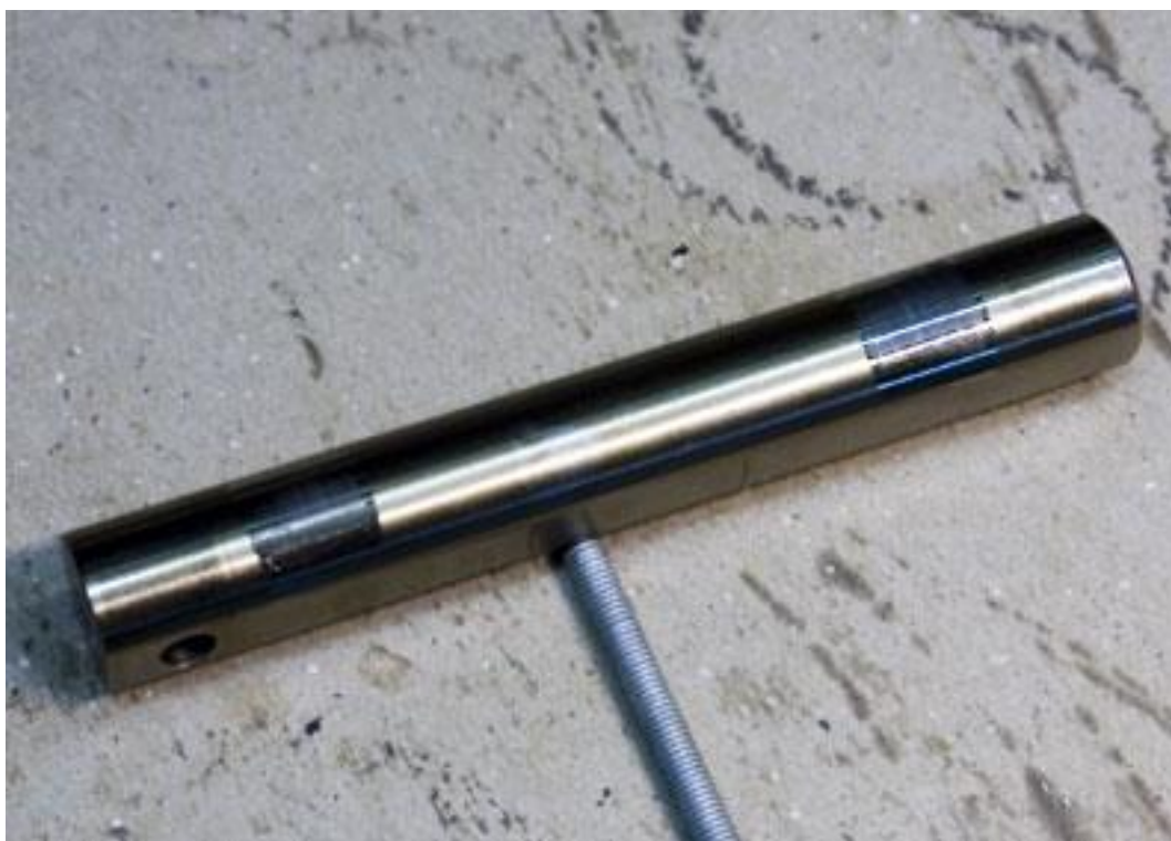
Фото 11: Палец оси сателлитов главной передачи АКП.
