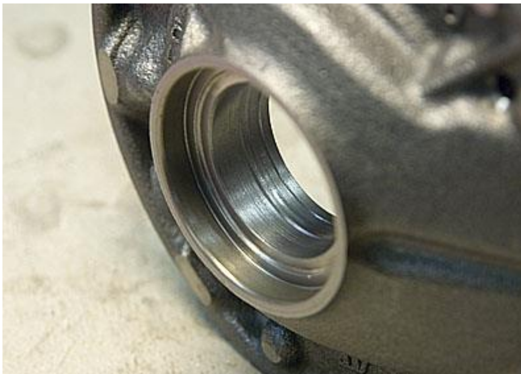
Фото 14: Посадочное место в корпусе насоса (№35035-21020) под подшипник скольжения (втулку) гидродинамического трансформатора.
