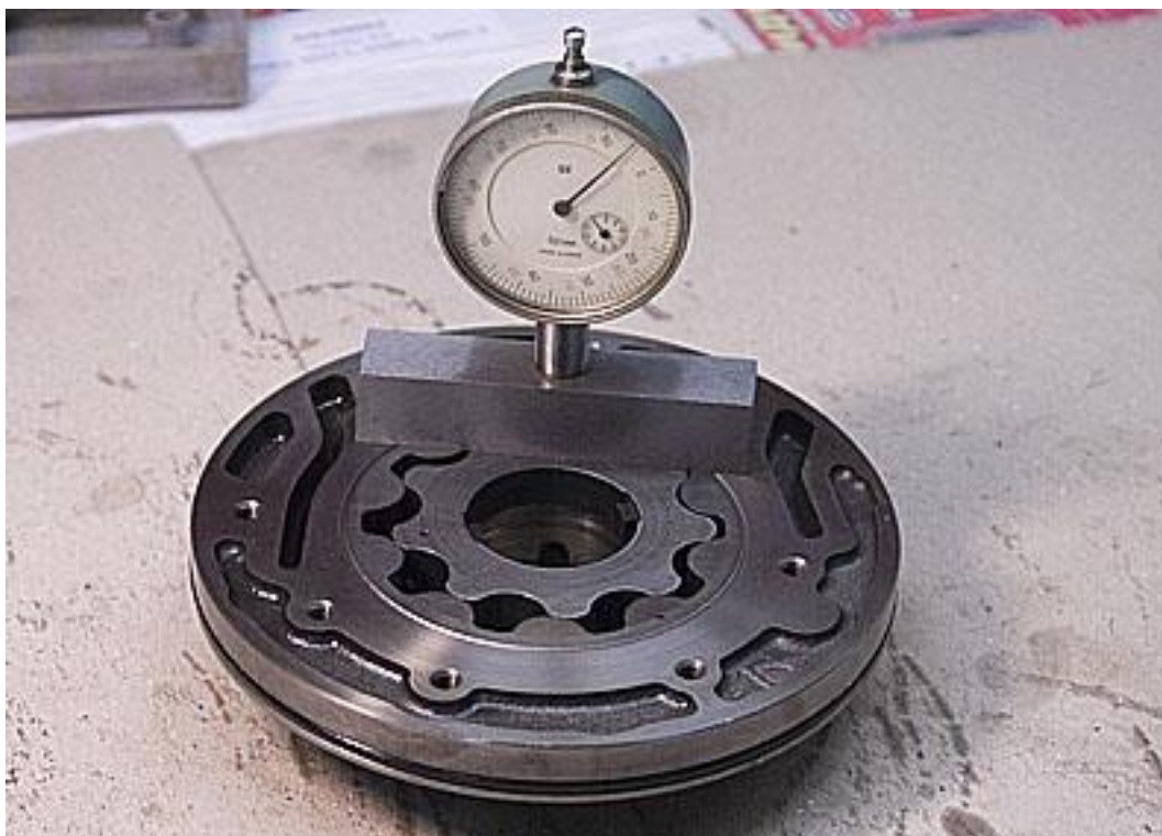
Фото 13: Измерение торцевого зазора насоса АКП.
