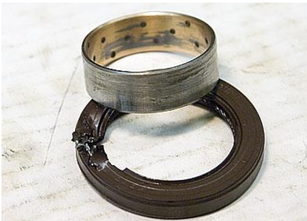
Фото 15: Подшипник скольжения (втулка) ГДТ и сальник насоса АКП.
