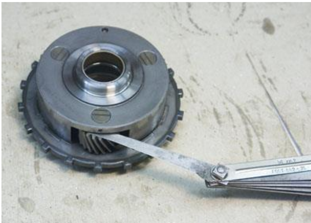
Фото 10: Измерение торцевого зазора в каретки планетарного ряда.
