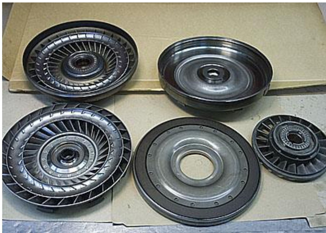
Фото 16: Детали разрезанного гидродинамического трансформатора.
