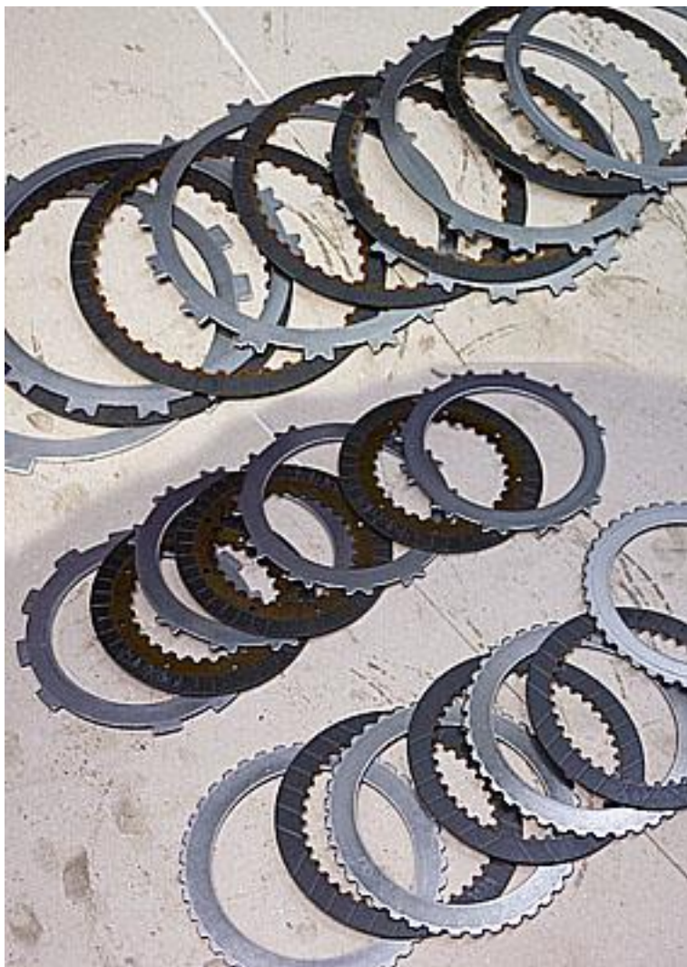
Фото 7: Пакеты фрикционных дисков (сверху вниз) тормоза заднего хода, сцепления и тормоза понижающей передачи.
